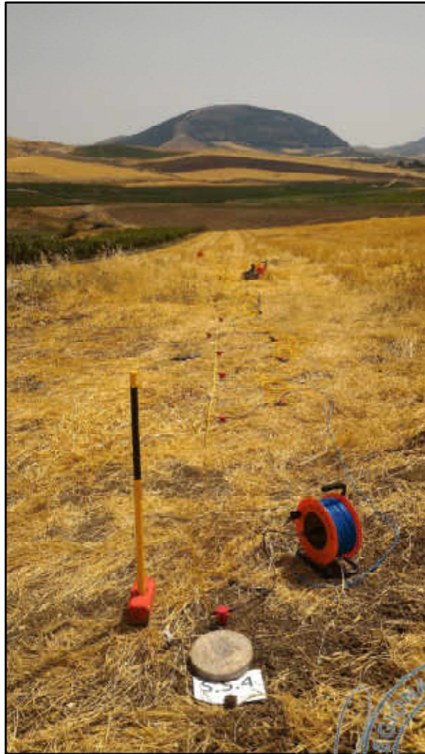
Figura 10: SS4 - Stendimento sismico
