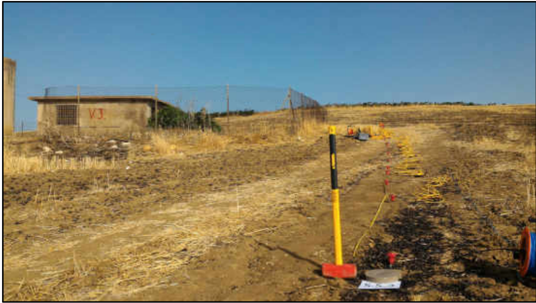
Figura 9: SS3 - Vasca 3 - Stendimento sismico
