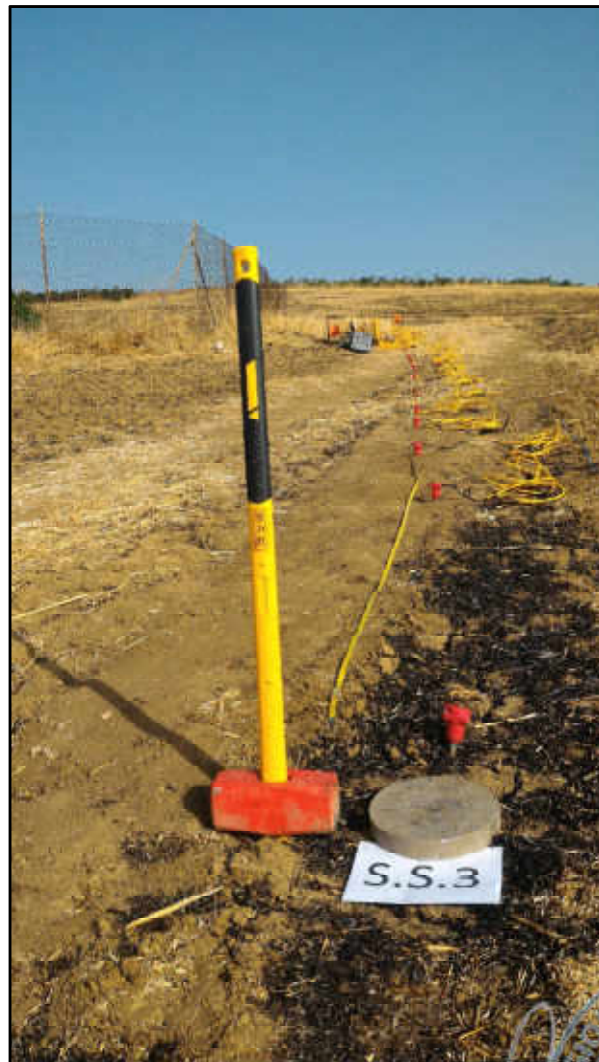
Figura 7: SS3 - Stendimento sismico
