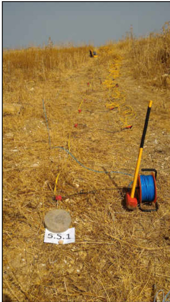
Figura 1: SS1 – Stendimento sismico
